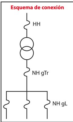
**Condiciones de trabajo:** Fusibles diseñados para soportar condiciones de trabajo extremas, tales como las que se presentan en gabinetes o cámaras: Temperaturas de -10 a + 45°C, Humedad máxima 95%.
